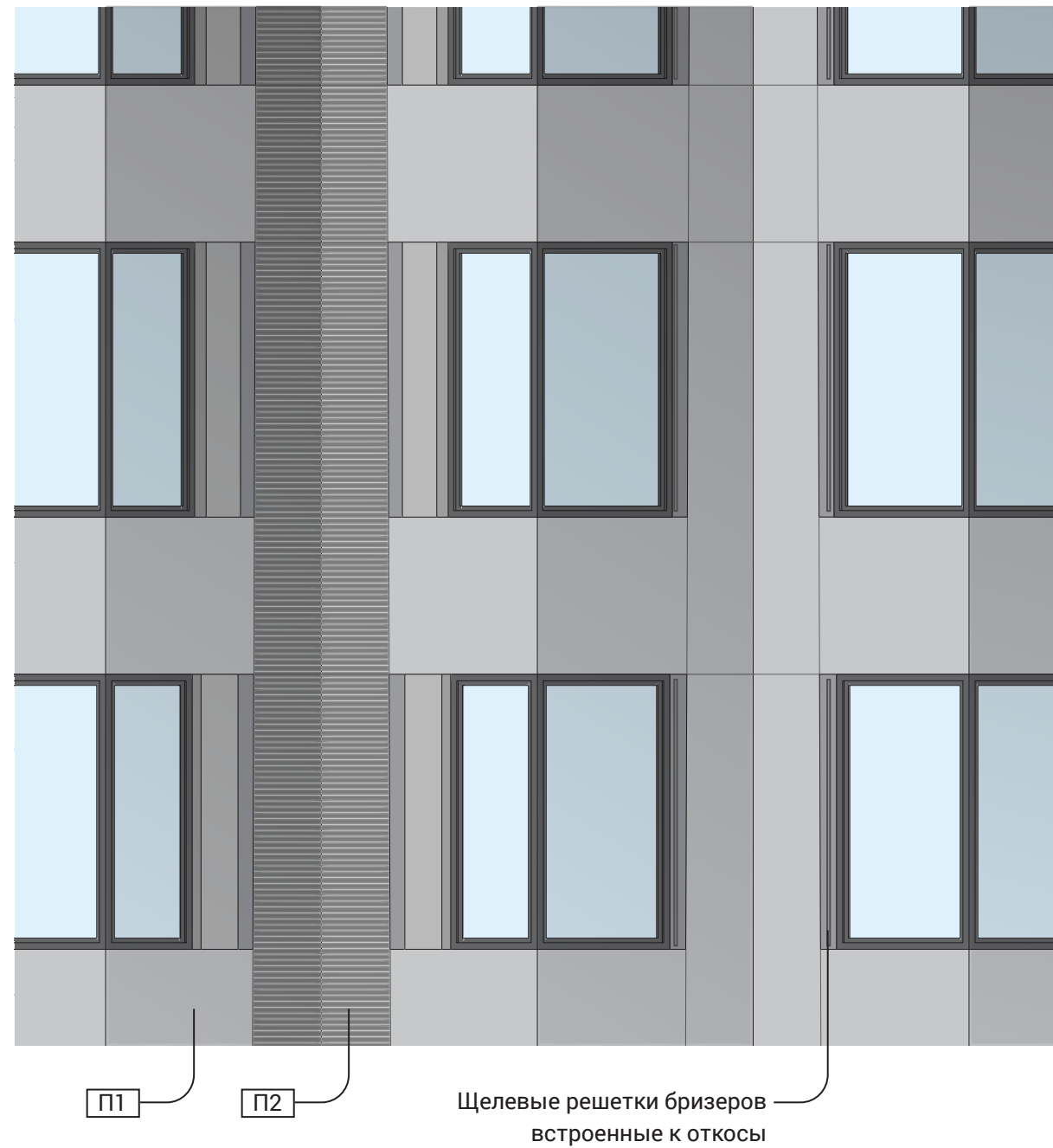
Фрагмент фасада с разрезкой на панели
